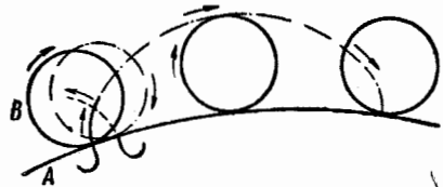
Фиг. 92. Принцип построения головки зуба.
