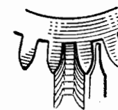
Фиг. 88. Фрезерование зубьев колеса с правильной последовательностью обработки зубьев.
